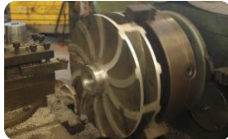
Turbina para bomba
